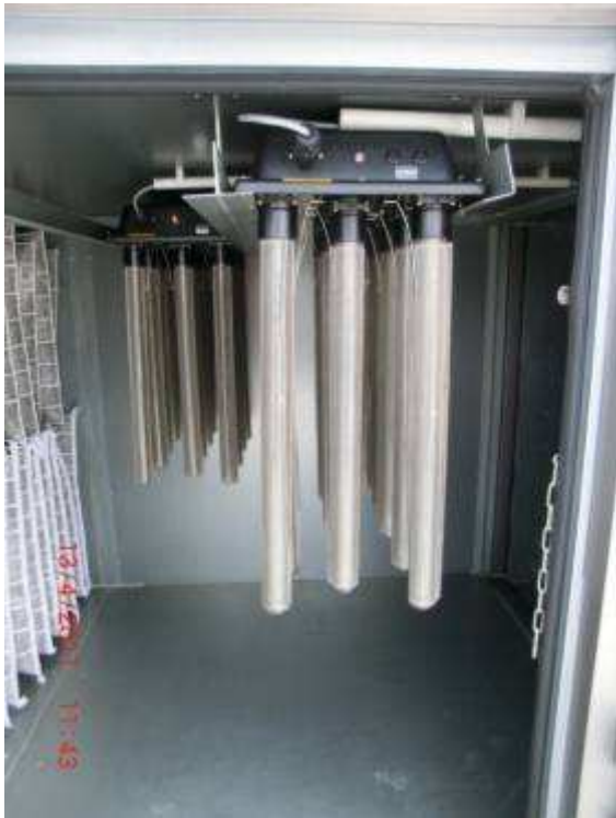
Abb. 5: Corona-Plasma Abluftreinigungssystem (Abb. Tale-Yazdi)
