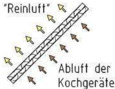
Abb. 3: Prinzipdarstellung eines Aerosolabscheiders (Abb. Tale-Yazdi)
